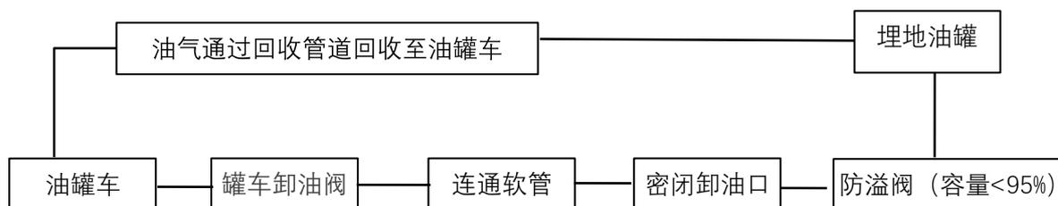
图 2.6-3 汽油罐车卸油工艺流程框图
