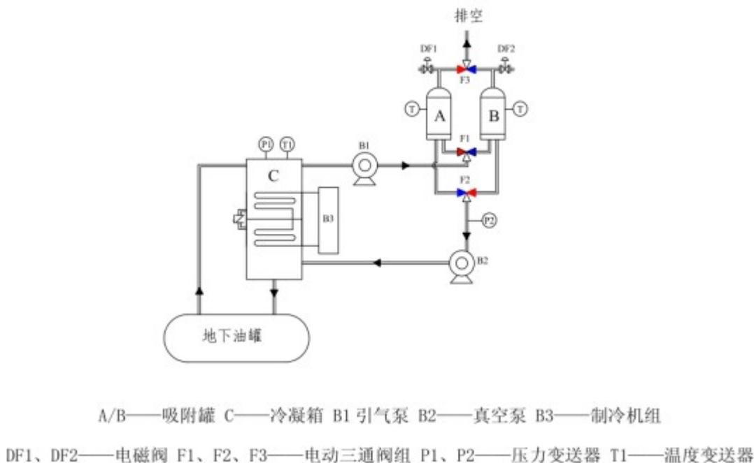
图 2.6-5 三次油气回收工艺流程图
