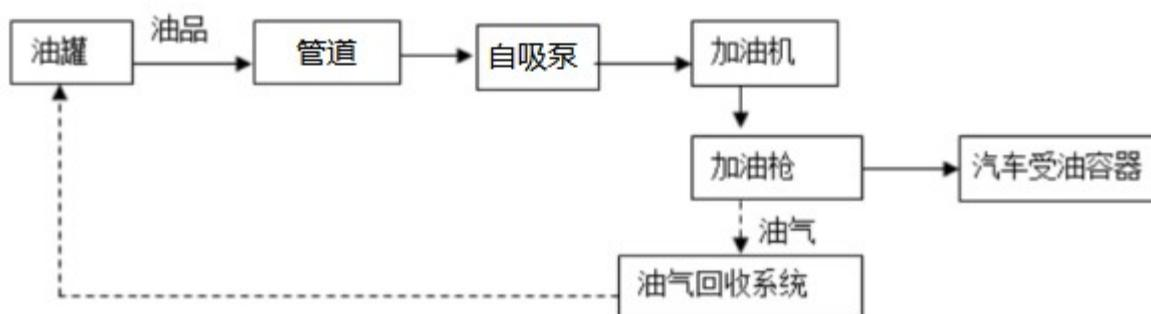
图 2.6-4 汽油加油工艺流程框图
