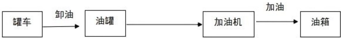
图 2.6-2 柴油卸油、加油工艺流程图
