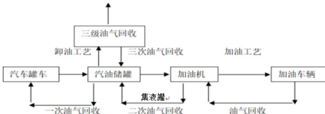
图 2.6-1 汽油卸油、加油、油气回收工艺流程图
