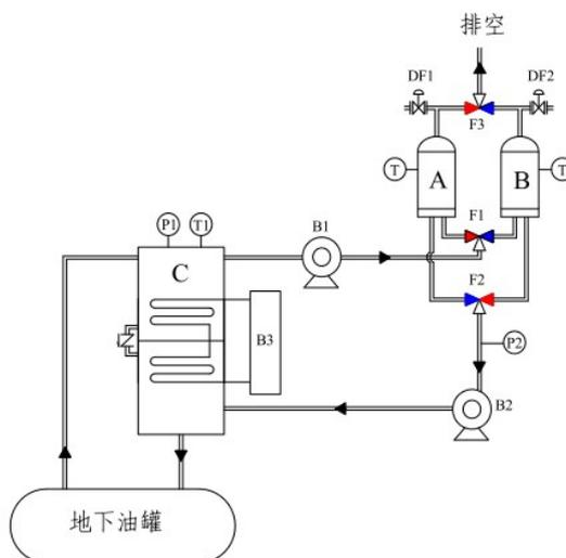
A/B——吸附罐 C——冷凝箱 B1 引气泵 B2——真空泵 B3——制冷机组
