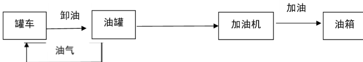
图 2.6-2 柴油卸油、加油工艺流程图
